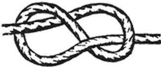
**Cote:** Es una vuelta en la que se pasa el chicote de un cabo alrededor del firme dándole una ligada que produce el trincado del cabo.
